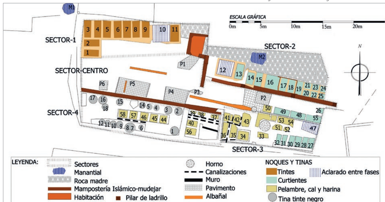
Figura.2.Plano.2 Planta general de las tenerías.
