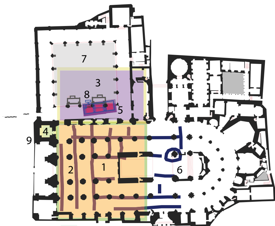
Fig. 5 . De la Mezquita a la Catedral. Superposición de las plantas: 1. Planta de la mezquita aljama. 2. Cimentación de las naves. 3. Patio. 4. Alminar. 5. Aljibe. 6. Planta de la Catedral. 7. Claustro. 8. Pozo de la noria. 9. Torre.
